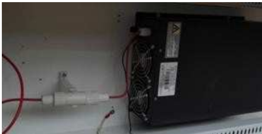
Figure 3-12 Diagrama de Fixamento Terminal de Alta Tensão Positiva
